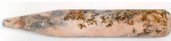
Deze DU-penetrator vertoont geelkleurige oxidatie.
